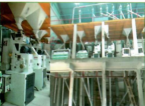
একতা অটো রাইস মিল, বাগদাহাট, শেখারাব, গাইবান্ধা। প্রতিদিন ৯৬ টন কমতাসম্পন্ন পারবয়েলিং, ড্রায়ার, ৮ টন মিলিং ও ৫ টন বয়লার।
