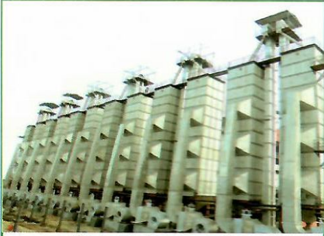
বিখাস এগ্রো ফুড লিমি, অল্ডারদুর্গা, কুষ্টিয়া। প্রতিদিন ১৭৬০ টন কমতাসম্পন্ন পারবয়েলিং এবং ড্রায়ার
