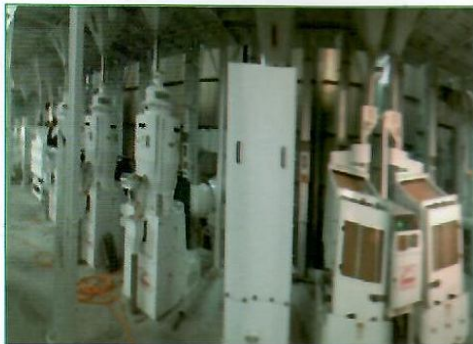
মিতালি অটো রাইস মিল, নারায়ণী, ধানাই, ঢাকা। প্রতিদিন ৯৬ টন কমতাসম্পন্ন পারবয়েলিং, এবং ড্রায়ার ও ৮ টন মিলিং।
